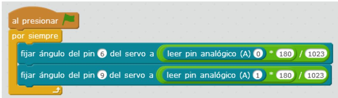
3. Para variar el ángulo del servomotor con el movimiento del joystick harás la siguiente operación matemática:
