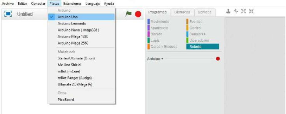
2.3 Configura el puerto de trabajo de tu placa Build&Code 4in1: abre la pestaña “Conectar”, selecciona la opción “Puerto serie” y selecciona el puerto COM en el que esté conectada la placa.
