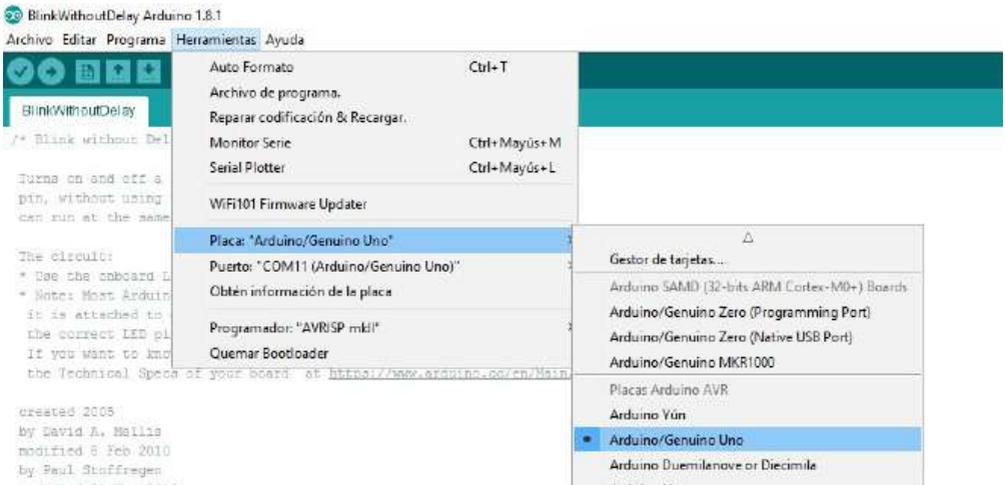
2.3 Configura el puerto de trabajo de tu placa Build&Code 4in1: ve a la pestaña “Herramientas”, haz click en la opción “Puerto” y selecciona el puerto COM en el que esté conectada la placa.
