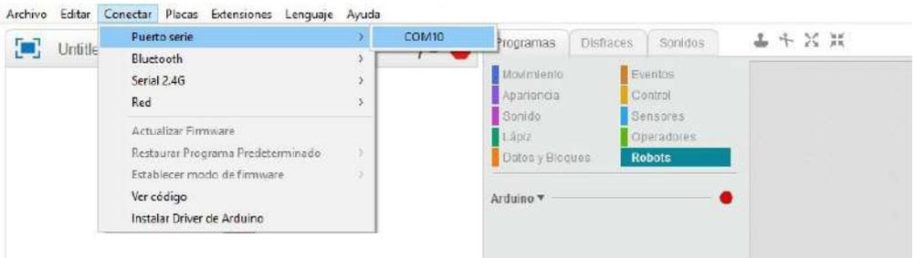
2.4 Luego, el software se sincronizará con la placa Build&Code 4in1. Para comprobar que la sincronización se ha realizado correctamente, comprueba que el círculo que se muestra junto a los bloques de Arduino (indicado con el recuadro rojo) sea de color verde. También comprueba que arriba, al centro, se indique “Puerto serie Conectado” (tal como se muestra dentro del rectángulo rojo).
